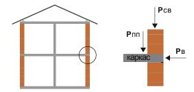
**Рсв** – нагрузка от собственного веса стены, **Рпп** – нагрузка от перекрытий и покрытий, **Рв** – ветровая нагрузка.
