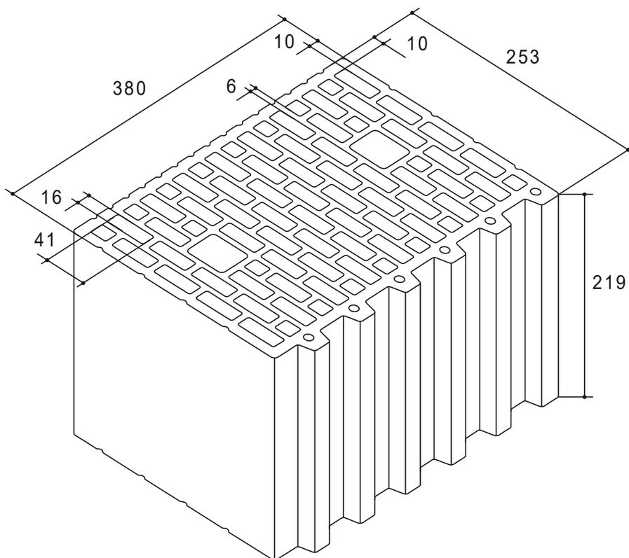
**Поз. 24** - камень керамический с пазогребневым соединением доборный для вертикальных монолитных железобетонных сердечников POROMAX-380-D-vc (10.8НФ)
